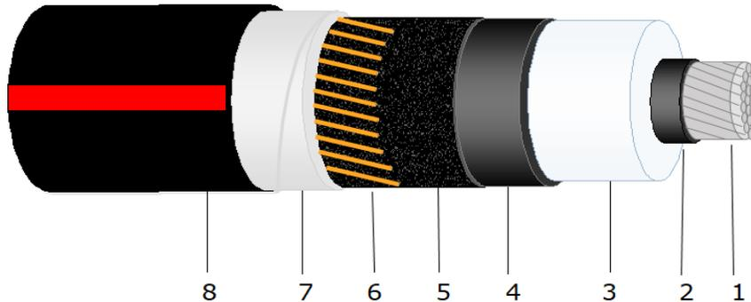
Los cables de potencia monopares son formados por conductor de aluminio 1350 duro compacto bloqueado, con pantalla semiconductora sobre el conductor, aislamiento de polietileno de cadena cruzada retardante a las arborescencias (XLP-RA), pantalla sobre el aislamiento extruida, cinta semiconductora bloqueadora de agua, pantalla metálica a base de alambres de cobre de 16 mm<sup>2</sup>, cinta bloqueadora de agua y cubierta de Polietileno de alta densidad negro con tres franjas rojas.
